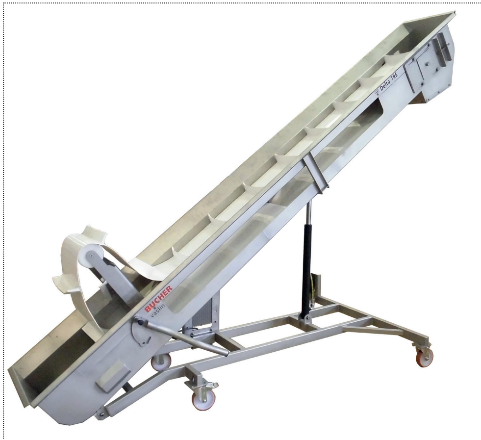
Delta TRE 300 with hopper under destemmer
